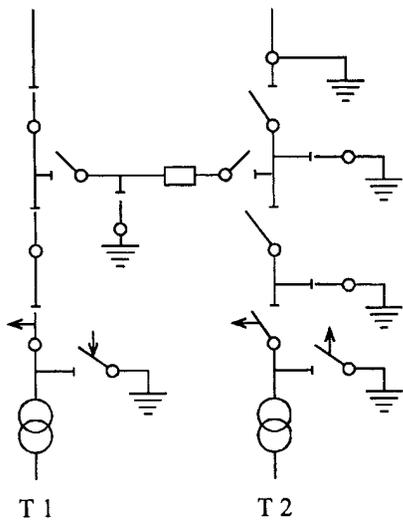
Рис. 4. Подстанция по схеме мостика.
