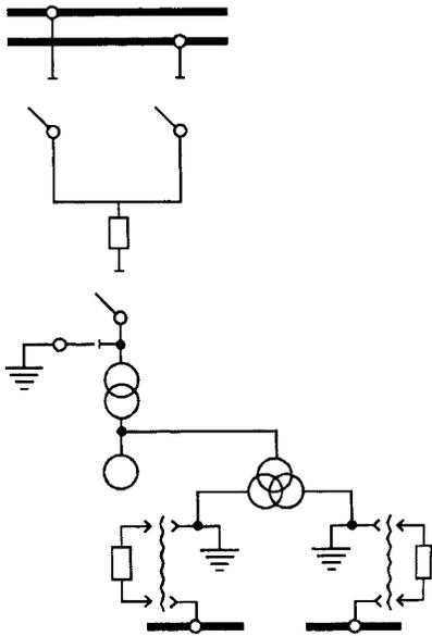
Рис. 5. Блок генератор – трансформатор.
