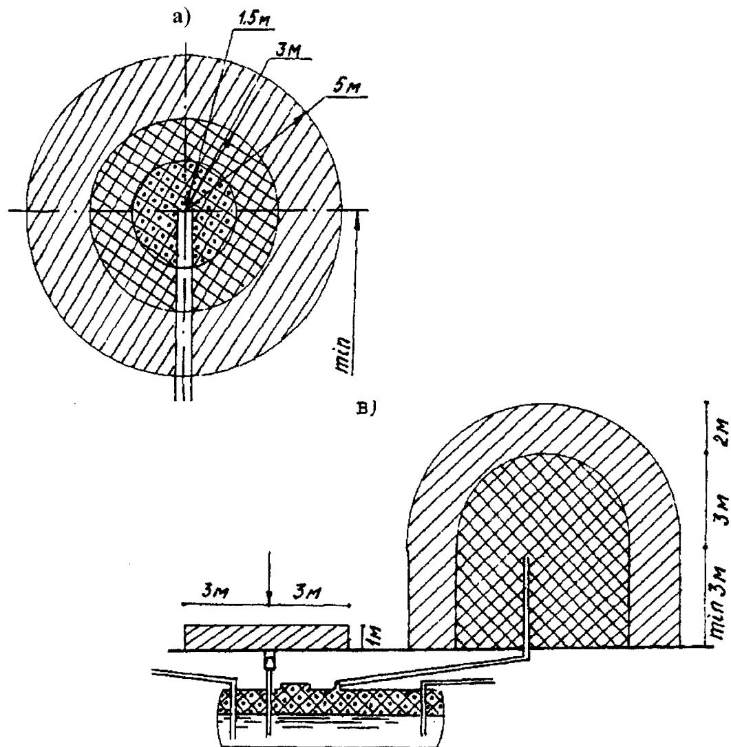
**Рис. 8. Открытые пространства вокруг окончания труб, отводящих попутные газы (а), и отверстий для выпуска газов (паров) из закрытых технических устройств (в)**
