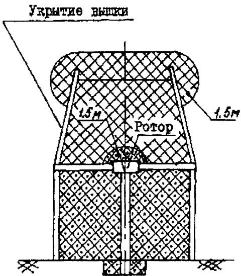
Буровая установка с ограждением подроторным пространством
