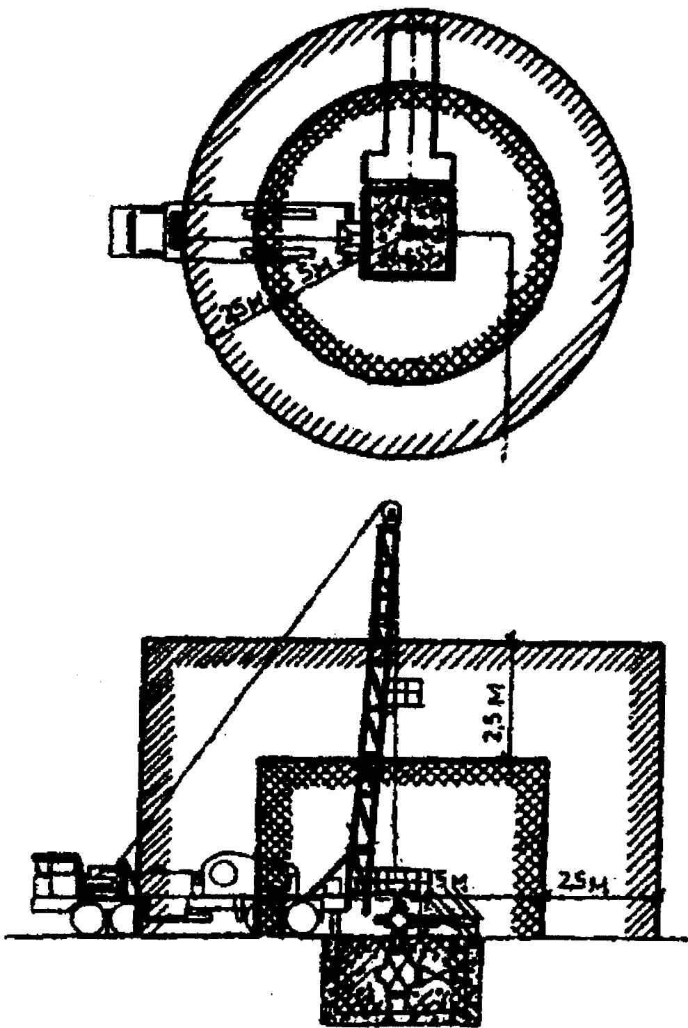
**Рис. 9. Агрегат для ремонта скважин**
